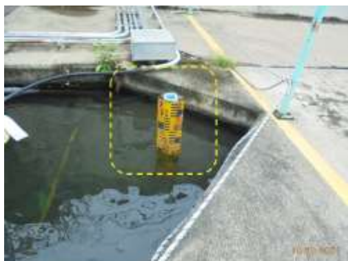
รูปที่ 20 (ต่อ) การติดตั้งเครื่องสูบน้ำและบรรทัดวัดระดับน้ำของโครงการ
